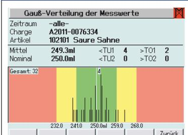
Anzeige der Gauß-Verteilung eines Produktes über mehrere Stichproben
