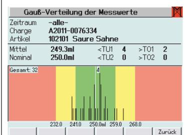
Anzeige der Gauß-Verteilung eines Produktes über mehrere Stichproben
